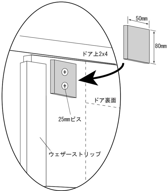
1. 壁合板と同じ素材の板 (50x80mm) を図の様に取り付けます。25mmビスはできるだけ板の中心ライン上に打ち付けて下さい。
